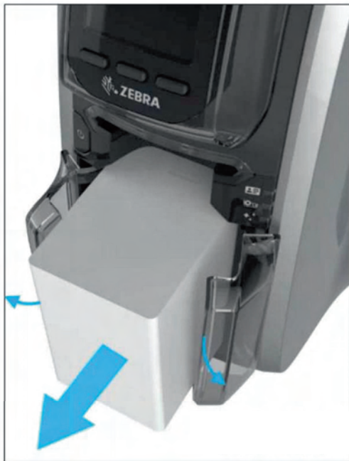
Trek een stapel kaarten eruit (klepjes schuiven automatisch open)
