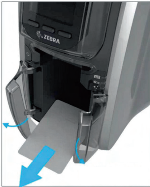
Trek een enkele kaart eruit (klepjes schuiven automatisch open)
